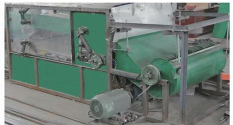
图9 清选装置试验台
