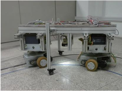
图6 双差速驱动移动机器人的原型系统
