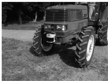
图5 自主导航拖拉机上安装的激光扫描仪
