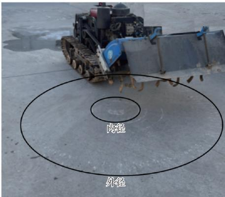
图19 最小转弯半径试验
