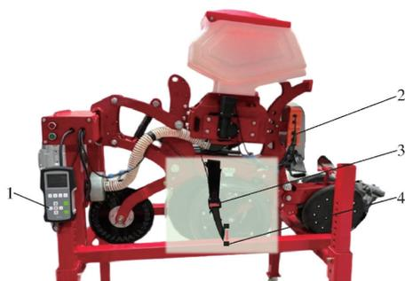
图6 时间差  $t_1$  测量试验台
