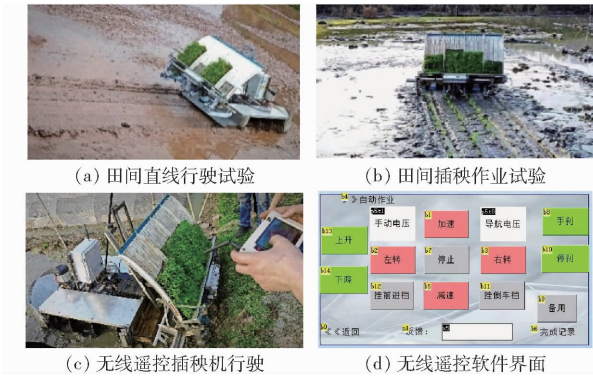
图 9 双螺旋驱动式插秧机田间试验
