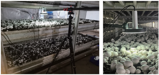
(a) 采集支架 (b) 深度相机和环形光源
