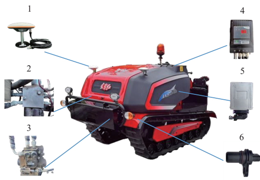
图5 差速转向控制系统组成
