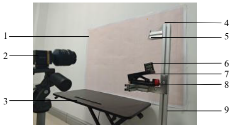
图 5 花生秧根茎碰撞恢复系数试验装置
