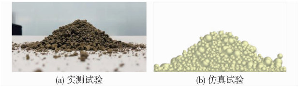
图 11 堆积试验结果 Fig. 11 Results of stacking test
