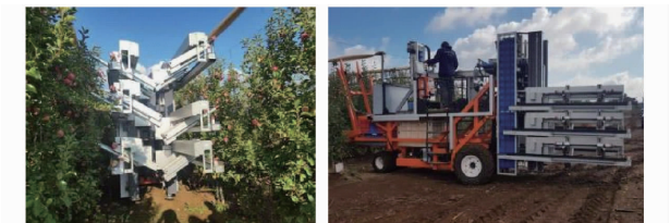
图 2 FF Robotics 的 12 臂大型苹果采摘机器人 Fig. 2 FF Robotics' 12-arm large apple harvesting robot
