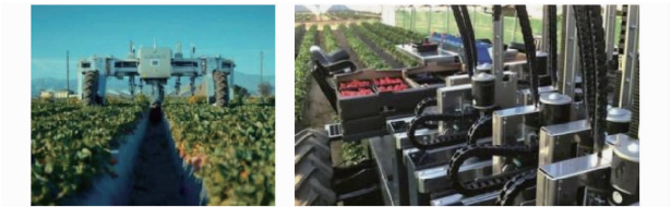
图 1 Agrobot 的 24 臂大型草莓采摘机器人 Fig. 1 Agrobot's 24-arm large strawberry harvesting robot
