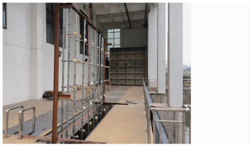
图 2 框架式流速仪现场安装示意图
