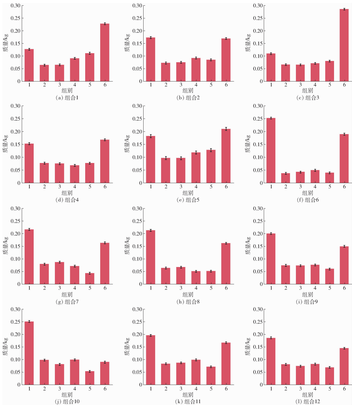
图 16 复合肥料颗粒在不同组合下各料管内颗粒沉积量台架试验结果
