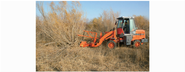
图 23 9GZ 系列灌木平茬机 Fig. 23 9GZ type sandy shrub harvester
