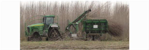
图 24 Stemster MKIII 系列灌木平茬机 Fig. 24 Stemster MKIII type shrub harvester
