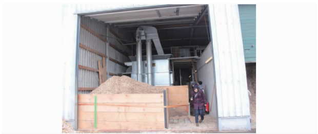
图 31 灌木木屑循环干燥设备
