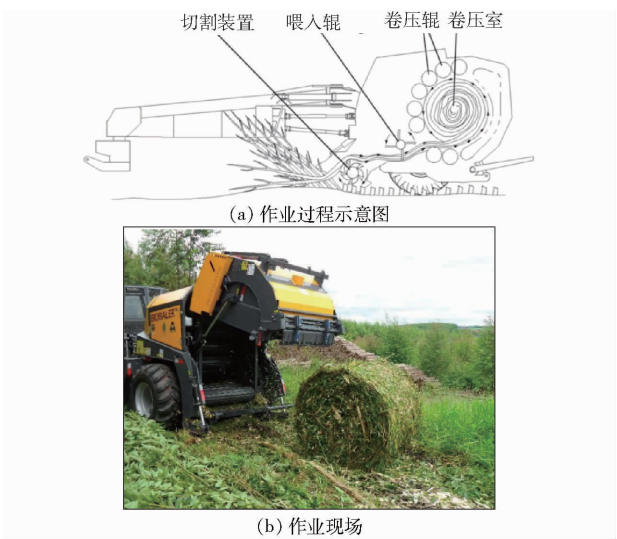
图 27 WB-55 型灌木平茬收割打捆机 Fig. 27 WB-55 biobaler
