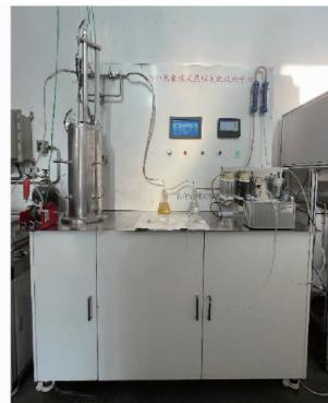
图 7 兼吸式移动床热解炭化装置实物图
