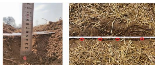
图 13 覆土厚度和种子粒距测量过程
