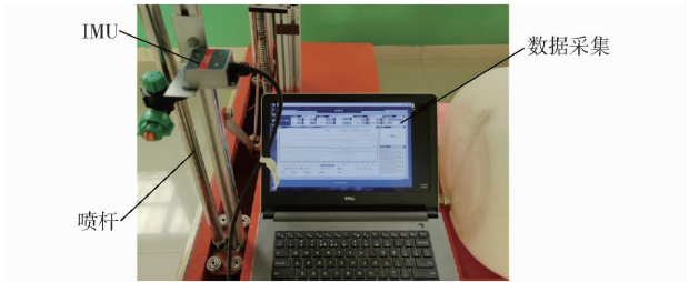
图 18 喷杆抖动试验 Fig. 18 Spray rod shake test
