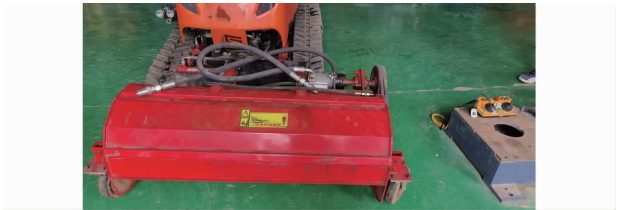
图 11 前置作业平台挂载试验
