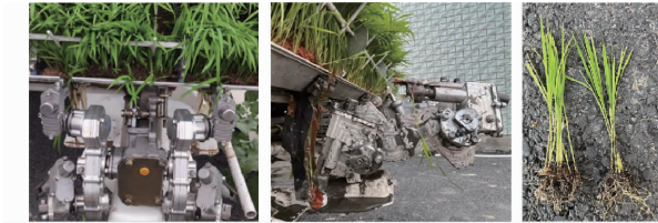
图12 分插机构取秧试验
