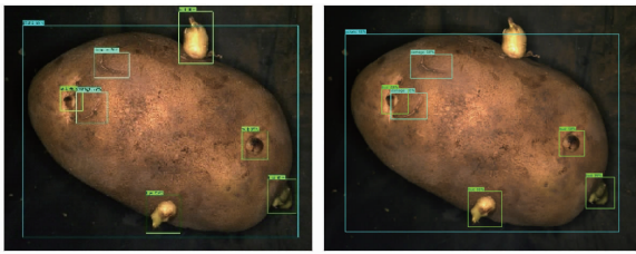
(a) 本文模型 (b) Faster R - CNN 图 11 马铃薯发芽与损伤在不同模型下的识别结果 Fig. 11 Identification of potato germination and damage under different models
