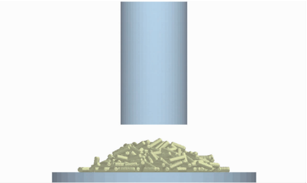
图 3 棉花秸秆仿真堆积角试验
