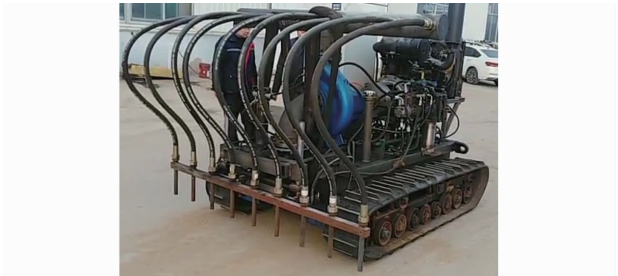
图 14 采藕机样机 Fig. 14 Prototype of lotus root harvester
