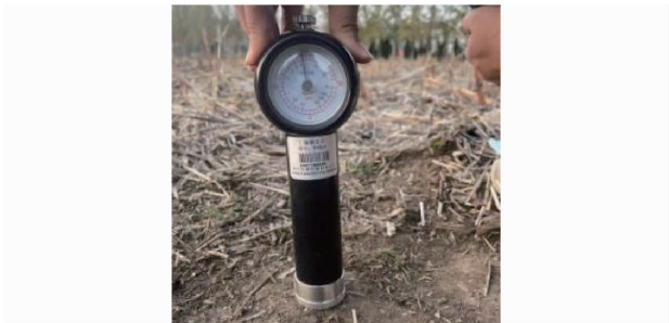
图 5 土壤硬度检测试验 Fig. 5 Soil hardness detection test
