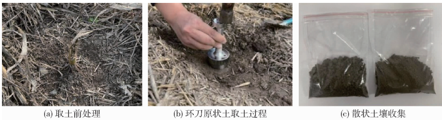
图 1 土壤取样 Fig. 1 Soil sampling
