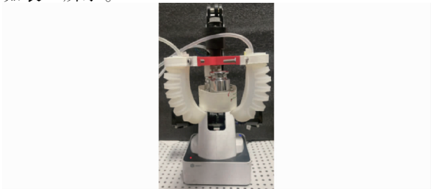
图 17 气动软体机械手负载能力试验 Fig. 17 Load capacity test of pneumatic soft manipulator
