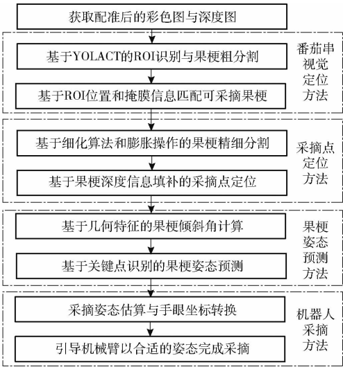
图 1 基于实例分割的番茄串视觉定位与采摘姿态估算方法
