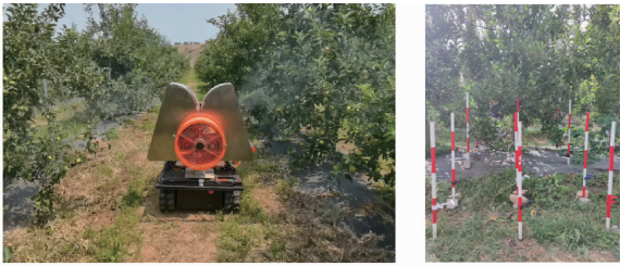
图 6 自走式小型靶标跟随喷雾机果园试验
