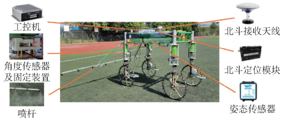
图 3 喷杆喷雾机及导航系统组成 Fig.3 Spray machine and navigation system
