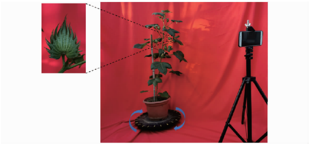
图 1 多视角棉花棉铃成像装置
