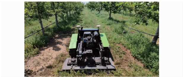
图 18 履带式割草机路径跟踪试验场景
