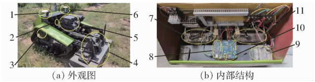
1、6. GNSS 天线 2、3. 履带驱动电机 4. 割盘 5. 发动机 7、11. 电机驱动器 8. 下位机 9. 动力电池 10. 遥控信号接收器
