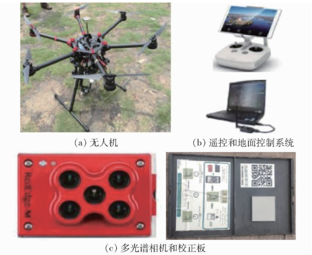
图 2 无人机多光谱影像采集系统
