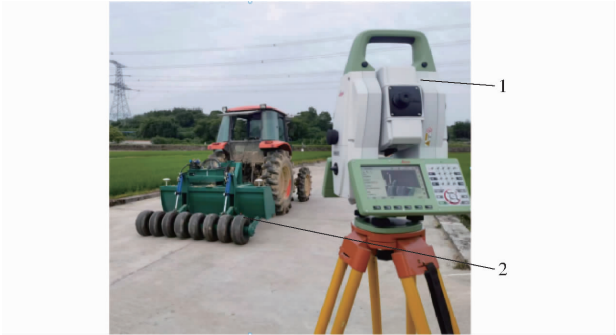
图 5 静态试验现场 Fig.5 Static test site 1. 全站仪 2. 棱镜
