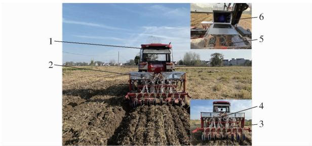
图 16 田间排种试验
