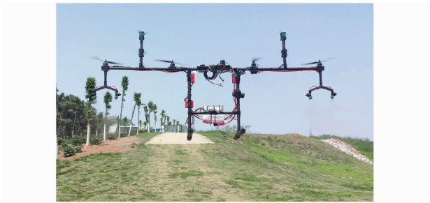
图3 直线型植保无人机试验平台
