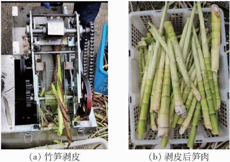
图 12 竹笋剥皮试验现场
