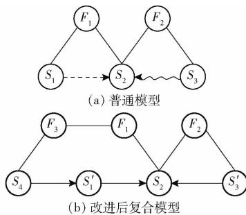
图2 种子玉米剥皮系统的“物-场”模型分析
