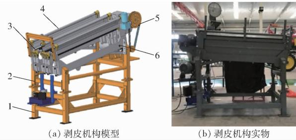
图3 种子玉米剥皮机构
