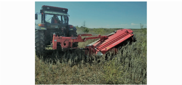
图 15 样机在 0^{\circ} \sim 28^{\circ} 的山丘作业现场
