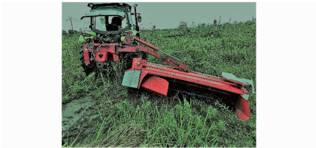
图 16 样机在 -24^{\circ} \sim 0^{\circ} 的洼地作业现场
