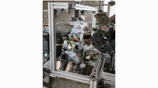
图 12 取苗-栽植试验现场
