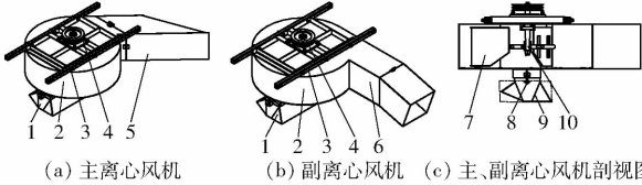
图 6 主、副离心风机结构简图
