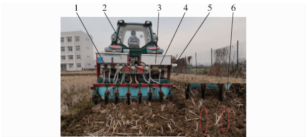
图 15 田间试验 Fig. 15 Field test 1. 油菜精量联合直播机 2. 拖拉机 3. 肥箱 4. 四头螺旋双行排肥器 5. 直流电机 6. 复合肥
