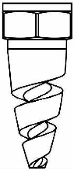
图 4 螺旋喷嘴结构示意图 Fig.4 Structure diagram of spiral nozzle
