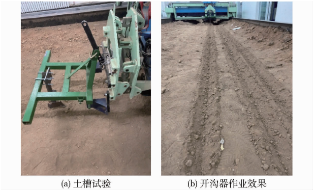
图 9 土槽验证试验
