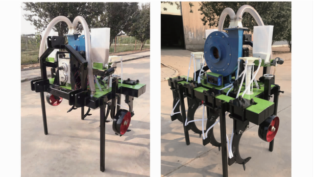
图 14 2BFQ-4 型多年生苜蓿切根松土补播施肥机样机
