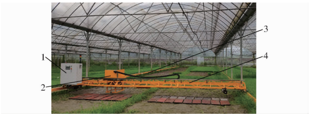
图 8 全自动龙门桁架式水稻秧盘摆放机 Fig.8 Structure of automatic gantry track type rice seedling trays laying machine 1. 控制柜 2. 铺盘小车 3. 纵向轨道 4. 龙门桁架
