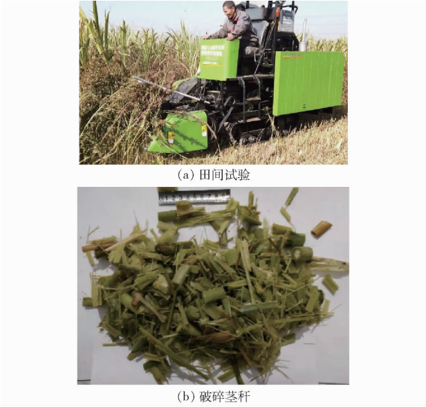
图 14 田间试验及破碎效果 Fig. 14 Field test and crushing effect
