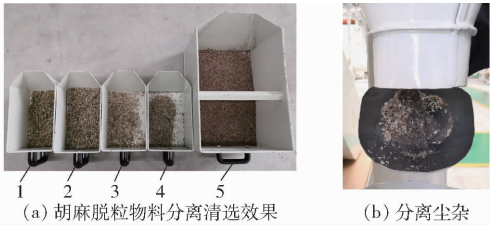
图 12 胡麻脱粒物料分离清选与除尘作业效果
