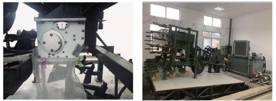
(a) 供种装置 (b) 播种机 图10 智能种植机械测试平台
