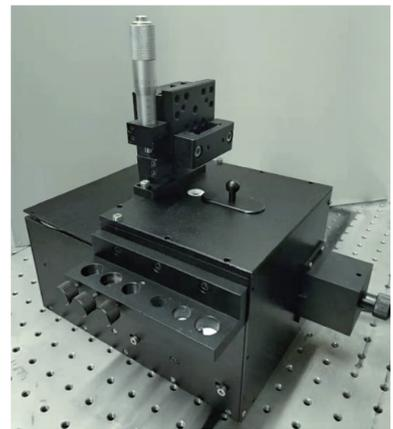
图4 表面增强剂与试样自动混匀控制装置实物图
