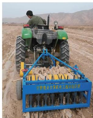
图9 残膜回收机作业性能田间试验
