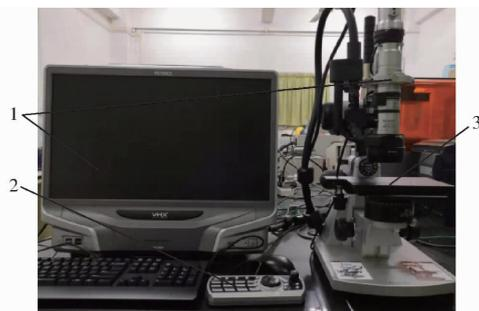
图 3 VHX-900F 型超景深三维显微镜
