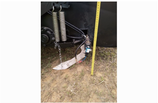
图 13 割台高度测量
